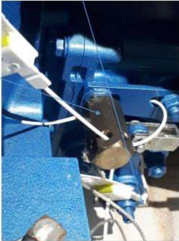
Le scellé doit être passé entre le trou situé au bout de cet écrou et une partie fixe du moteur.
